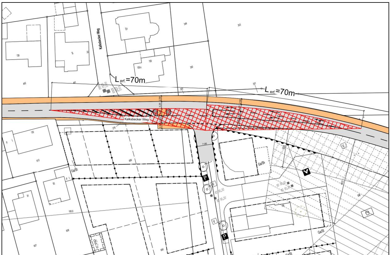
Abbildung 14: Verkehrstechnische Skizze – Überprüfung der Anfahrtsicht
