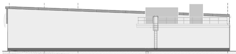
**Westansicht:** Putzfassade, Pfosten-Riegel-Konstruktion und Alucobondfassade
