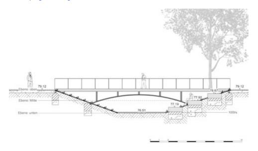
Neben den neuen Brücken schaffen Stufenanlagen in der Böschung die Möglichkeit zum Fluss zu gelangen, um sich dort aufzuhalten. Die Anordnung der Wege und Stufenanlagen ist mit einem vertretbaren Eingriff in den Baumbestand an der westlichen Brücke realisierbar. Die Stufenanlagen sollen in der Anmutung "Baumberger Sandstein" aus entsprechend eingefärbtem Beton gefertigt werden.
