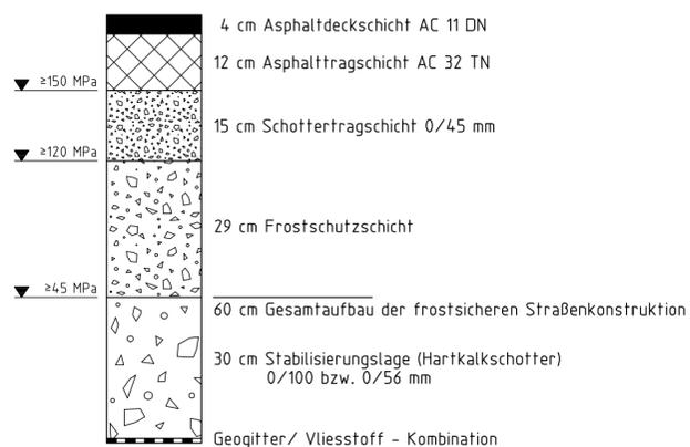
Es sind teilweise bis in einer Tiefe von 2,00 m organische Auffüllungen vorhanden die durch Böden der Bodengruppe SU/SW/SE zu ersetzen sind. Des Weiteren wurde teerhaltiges Material und Z 2-Böden vorgefunden, die einer geeigneten Entsorgung zugeordnet werden müssen.
