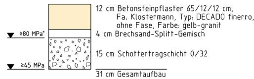
\*bei Belastung durch Fahrzeuge  $E_v \geq 100$  MPa
