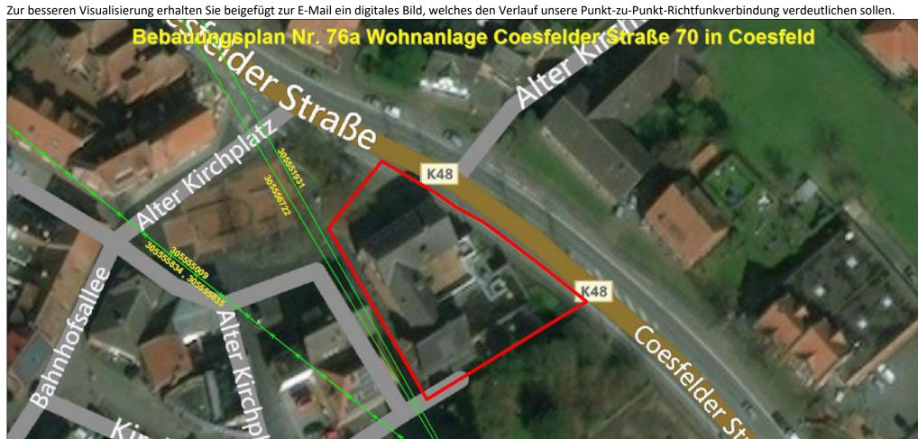
Die farbigen Linien verstehen sich als Punkt-zu-Punkt-Richtfunkverbindungen der Telefónica Germany GmbH & Co. OHG. Das Plangebiet ist im Bild mit einer dicken roten Linie eingezeichnet.
