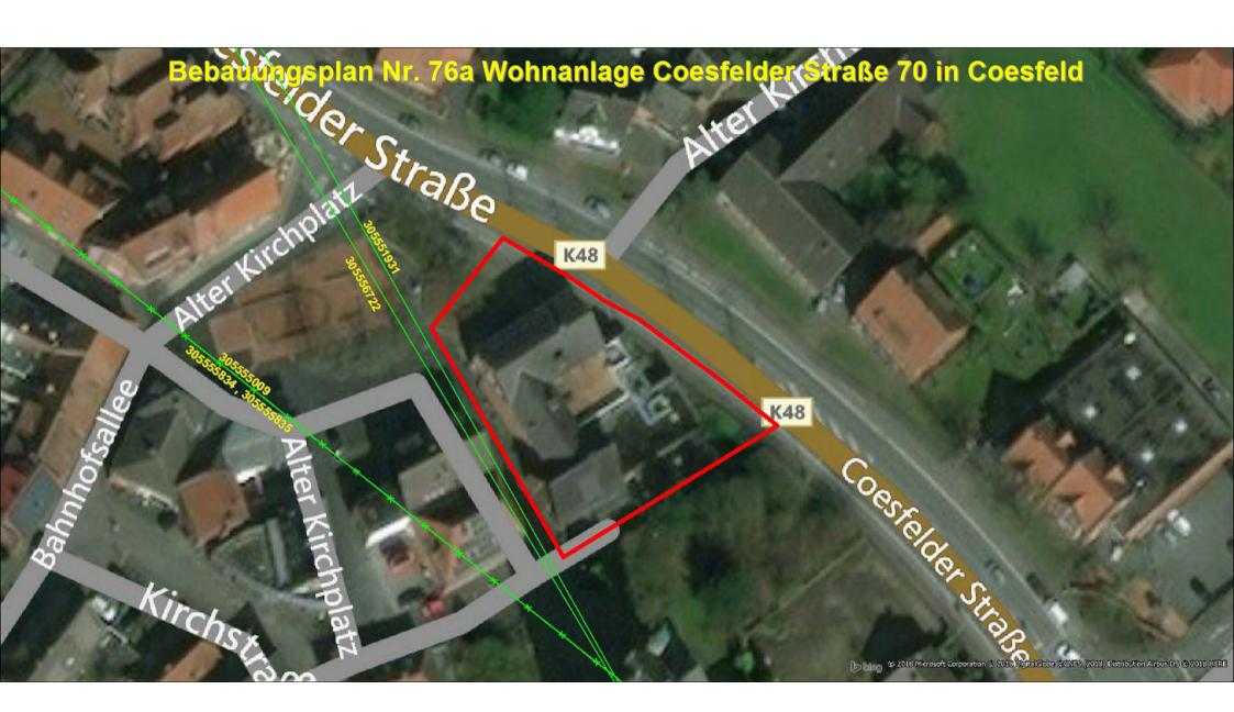
Die farbigen Linien verstehen sich als Punkt-zu-Punkt-Richtfunkverbindungen der Telefónica Germany GmbH & Co. OHG. Das Plangebiet ist im Bild mit einer dicken roten Linie eingezeichnet.
